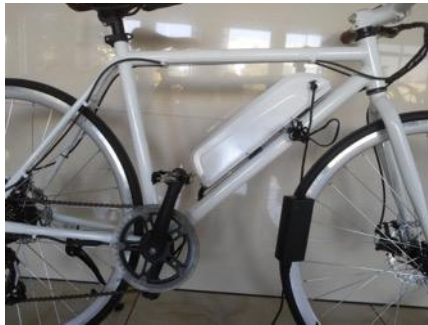
Figura 14 – Cavo del carica batterie collegato alla batteria d'alimentazione della bicicletta.
